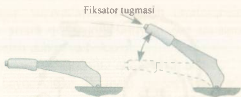
11-rasm. Qo'l tormozini ishga tushirish sxemasi.
