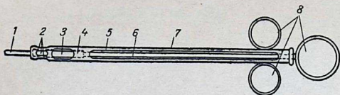
Рис. 36. Металлический капсуловводитель для осеменения овец: 1 — вывертыватель капсулы; 2 — окна для выхода спермы; 3 — окно для вкладывания капсулы; 4 — толкатель; 5 — окно для гайки; 6 — штанга толка- теля; 7 — трубка; 8 — кольца для пальцев.
