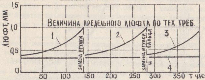
Рис. 8. Нарастание люфта нижней опоры шпинделя: 1, 2, 3 - нарастание люфта и достижение его предельного значения в серийной опоре, 4 - нарастание люфта шпинделя в шаровой опоре
