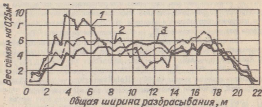
Рис. 8. Характер распределения семян риса по ширине разбрасывания: 1 - серийным центробежным аппаратом; 2 - экспериментальным без нижнего диска; 3 - экспериментальным с нижним диском.
