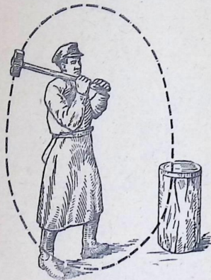
Рис. 51. Размашной удар кувалдой.
