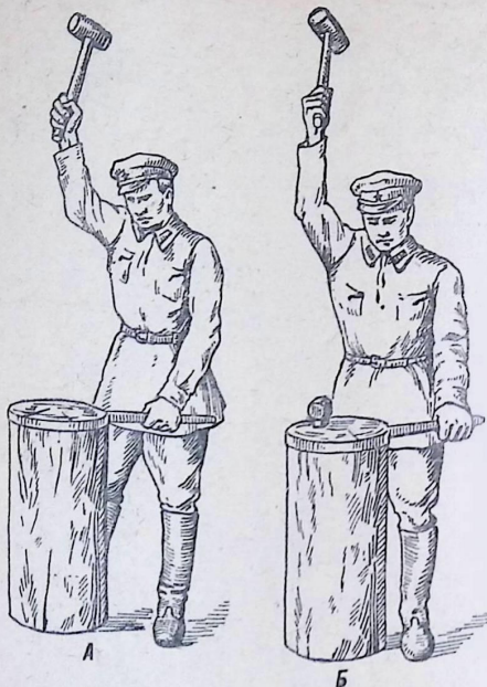
Рис. 45. Плечевой удар молотком: А — по деревянной тумбе; Б — по железной бабке.
