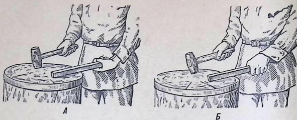
Рис. 47. Вращение деревянного бруска кистью левой руки на 90^\circ в направлении на себя:
