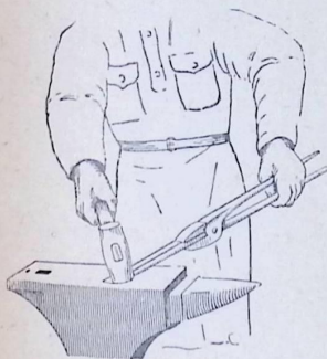
Рис. 53. Оттяжка конца бруска квадратного железа на конусе.
