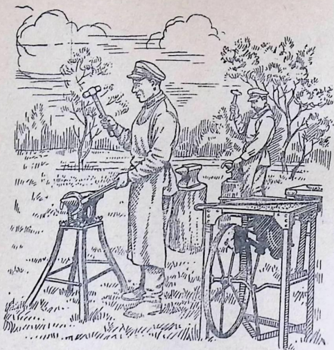
Рис. 33. Облегченная (полая) наковальня.
