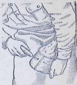
Рис. 122. Просверливание отверстия через края трещины.
