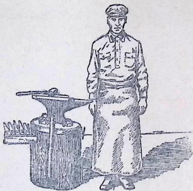
Рис. 29. Высота наковальни со стулом.
