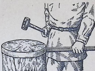
Рис. 43. Кистевой удар молотком по деревянной тумбе (удар).
