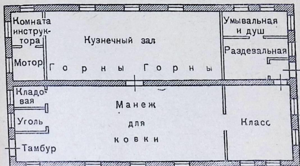
Рис. 20. План войсковой кузницы на 3 горна (6 огней).
