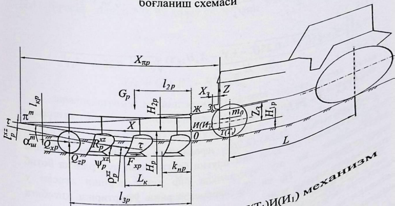
2.9-расм. Плугнинг тракторни олдига осиладиган қисмини у билан ЖЗТ(Т 1 )И(И 1 ) механизм орқали боғланиш схемаси
