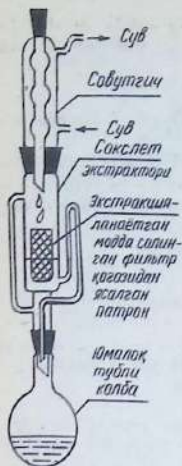
7-расм. Сокалет экстрактори каттик моддани эритувчи билан ёрдамида моддаларни ажратиш асбоби
