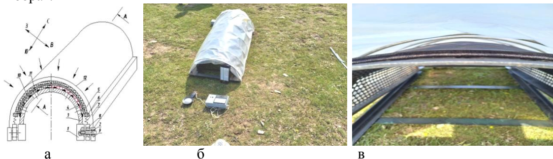
5-расм. Гелиоқуриткичнинг умумий кўриниши: а) схемаси; б)ташқи кўриниши; в)ички кўриниш: 1-рама; 2-қозиқ; 3-шахмат тартибли жойлашган тешикли ва ғадир-будурликли сирт юзали ярим цилиндрик метал тоқча;
