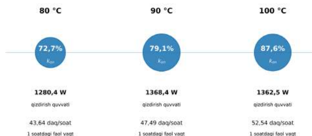
2-rasm. Qizdirish yuzasi haroratiga bog'liq elektrokontakt qizdirish tizimining ish rejimi.
