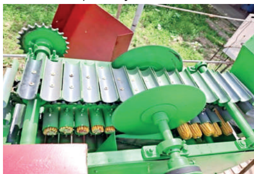
b) so'talarning yaroqsiz qismini ajratish qurilmasi
