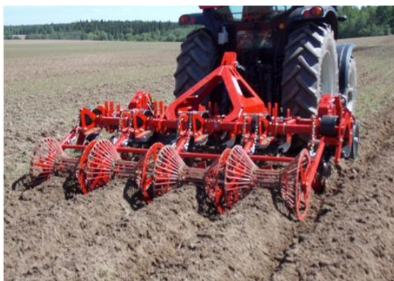
2-rasm. Pushta hosil qiluvchi korpus va profilli chiviqli g‘altaklar bilan jihozlangan kultivator
