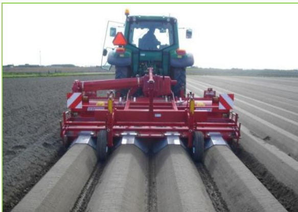
1-rasm. Pushta hosil qiluvchi plitalar bilan jihozlangan frezali kultivator
