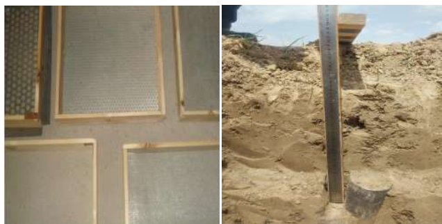
5-rasm. Tuproqning namligi, qattam chuqurliklaridan namuna
