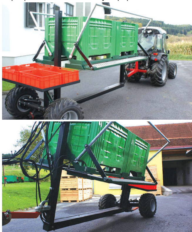
Рис.3. Платформа, предназначенная для уборки урожая, обрезки и ухода за садом.
