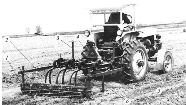
7-расм. НО-3.0 ғалтакмолали чизель-культиватори иш жараёнида: 1 – тишли-планкали ғалтакмола; 2 – грядиль; 3 – тағқўйма; 4 – осма қурилмаси; 5 – рама; 6 – эластик устунли пасив иш органлари
