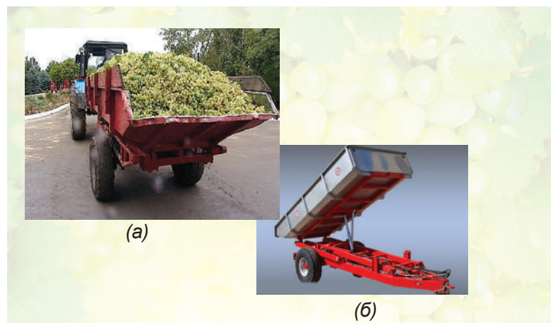
Рис.4. Полуприцеп перегрузчик саморазгружающийся: а) ТВС 2; б) ППВЗ
