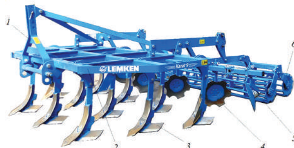
12-расм. “KARAT-9/300” тупроққа интенсив ишлов берувчи культиватор: 1 – осма қурилмаси; 2 – рама; 3 – пассив иш органлари; 4 – дискимон иш органи; 5 – труба-симон ва 6 – планкали ғалтакмоалар
