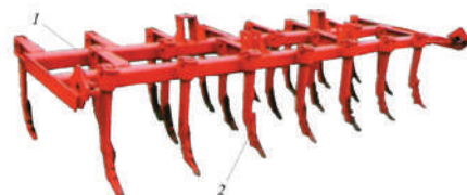
11-расм. 1. КЗЕ-15 чизель-культиватори: 1 – рама; 2 – юмшатувчи панжали иш органлари
