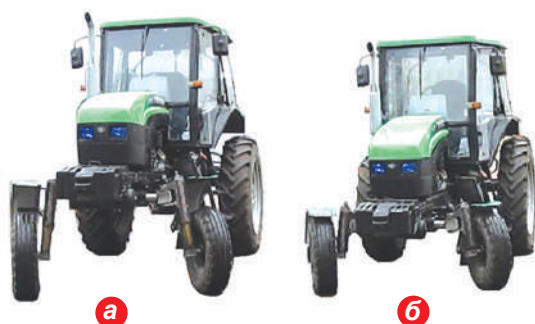
Рис. 1. Экспериментальный образец универсально-пропашного трактора с регулируемым клиренсом:
