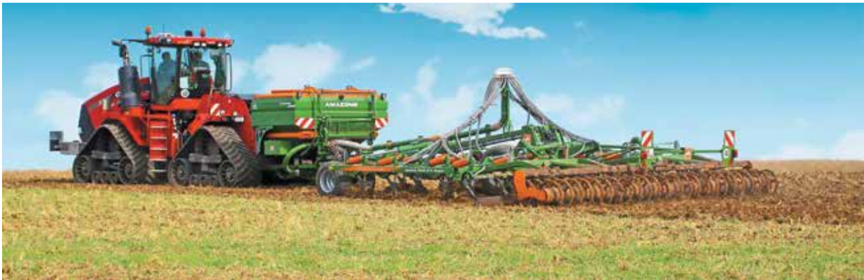
Рис. 1. а — комбинированный агрегат AMAZONE для внутрипочвенного внесения минеральных удобрений; б — навесной бункер для удобрений объемом 4,2 м 3 ; в — комбинированный рабочий орган культиватора Senius для обработки почвы и внутрипочвенного внесения удобрений
