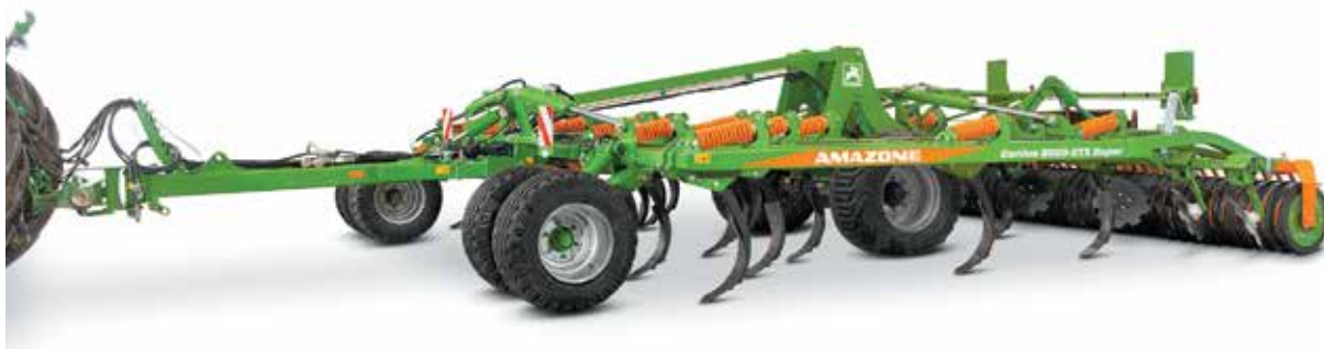
Рис. 2. Мульчирующий прицепной культиватор Cenius 6003-2TX Super с рабочими органами: а — стрельчатая лапа C-mix 320; б — C-mix 350; в — C-mix 100; г — C-mix 80
