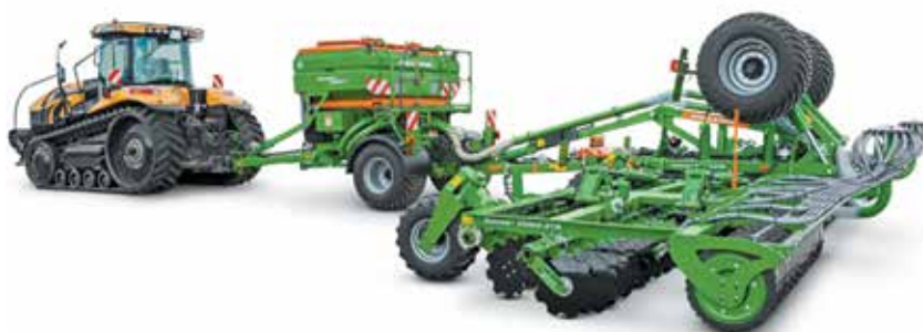
Рис. 3. Комбинированный агрегат в прицепном варианте X-TenderT с дисковой бороной-дискатором Catros
