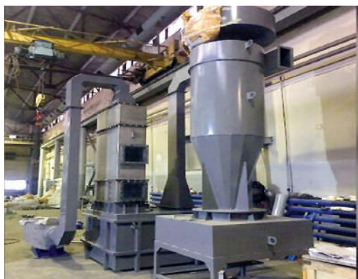
Рис.2. Аппараты очистки при образовании вихревого водо-воздушного слоя
