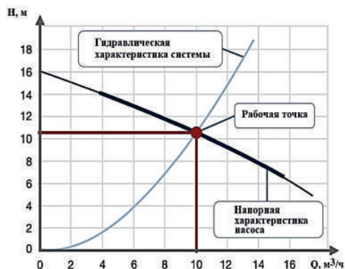
Рис. 1. График зависимости потерь при рециркуляции от расхода
