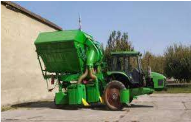
1-расм. 60 см қатор орасида экилган ғўза ҳосилини (икки ўтишда: биринчи терим кўсақлар 50-60 % очилганда-машина иш тезлиги - 4,13 км/соат; иккинчи терим ғўза кўсақлари қўшимча 20-30 % очилганда – машина иш тезлиги 5,32 км/соат) териб олишга мўлжалланган МХ-2,4 русумли вертикал-шпинделли пахта териш машинаси
