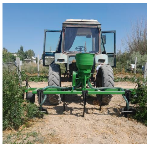
3-rasm. Anor qator oralarini tuproqlarini chuqur yumshatiladigan va o‘g‘itni tasmasimon usulda soladigan mashina
