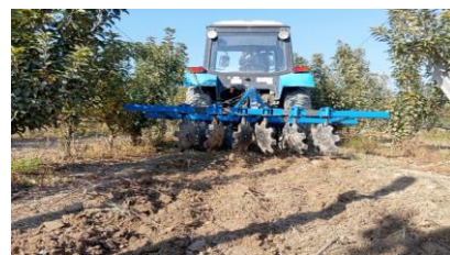
1-rasm. Intensiv bog‘larning turli kenglikdagi qator oralariga ishlov beradigin qurilmaning ish jarayonidagi ko‘rinishi
