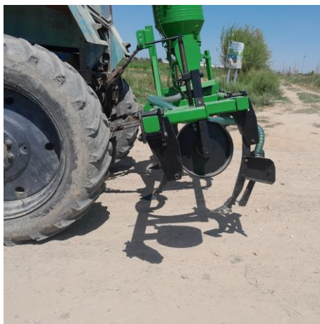
3-rasm. Anor qator oralarini tuproqlarini chuqur yumshatiladigan va o‘g‘itni tasmasimon usulda soladigan mashina
