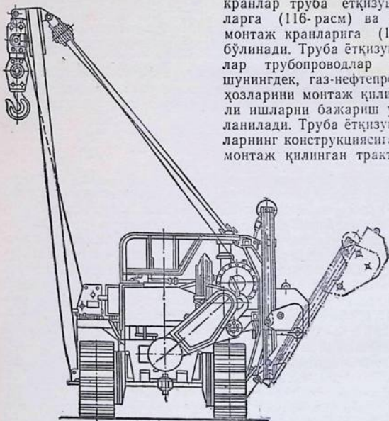
116-расм. Тракторга ўрнатилган труба ётқизувчи кран.
