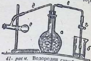
41- расм. Водородни сиқиб чиқариш усули билан металл эквивалентини аниқлаш асбоби.
